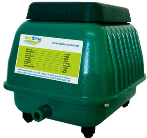
La serie de soplantes de aire “ECO”, de bajo consumo eléctrico y mantenimiento, utiliza tecnología de oscilación electromagnética y movimiento de bombeo, por medio de membranas, para suministro de aire totalmente seco, no contaminante y libre de partículas y aceites.
