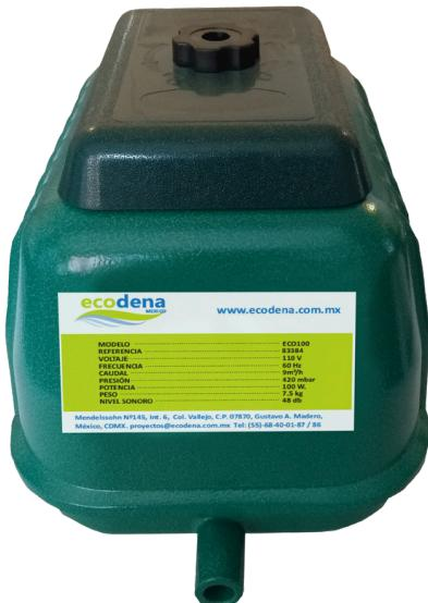
La serie de soplantes de aire “ECO”, de bajo consumo eléctrico y mantenimiento, utiliza tecnología de oscilación electromagnética y movimiento de bombeo, por medio de membranas, para suministro de aire totalmente seco, no contaminante y libre de partículas y aceites.
